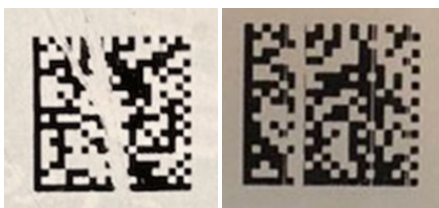
Нарушение целостности КМ*
