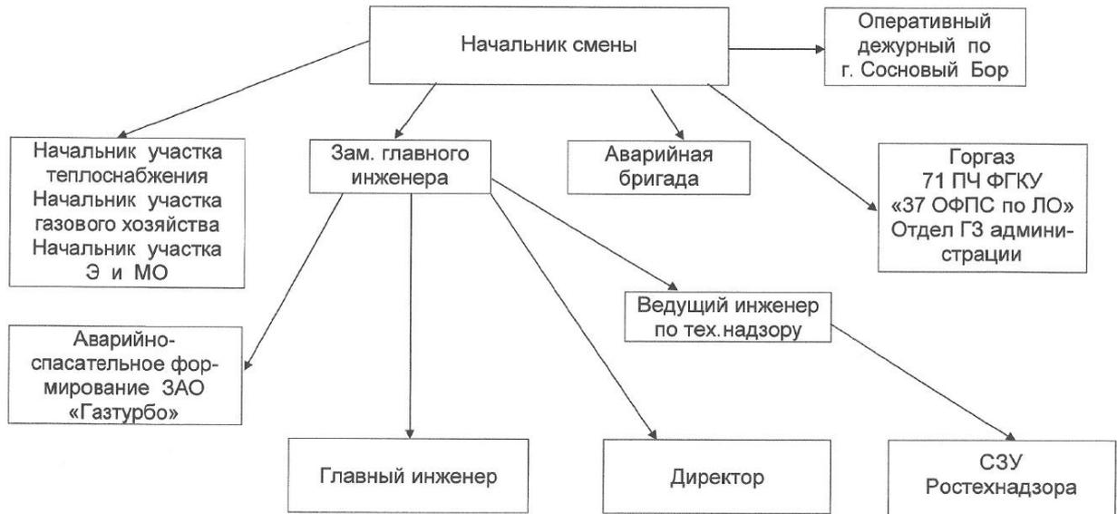
**Рисунок 43 - Схема оповещения (при авариях, связанных с объектами СМУП «ТСП» подконтрольными СЗУ Ростехнадзора)**
